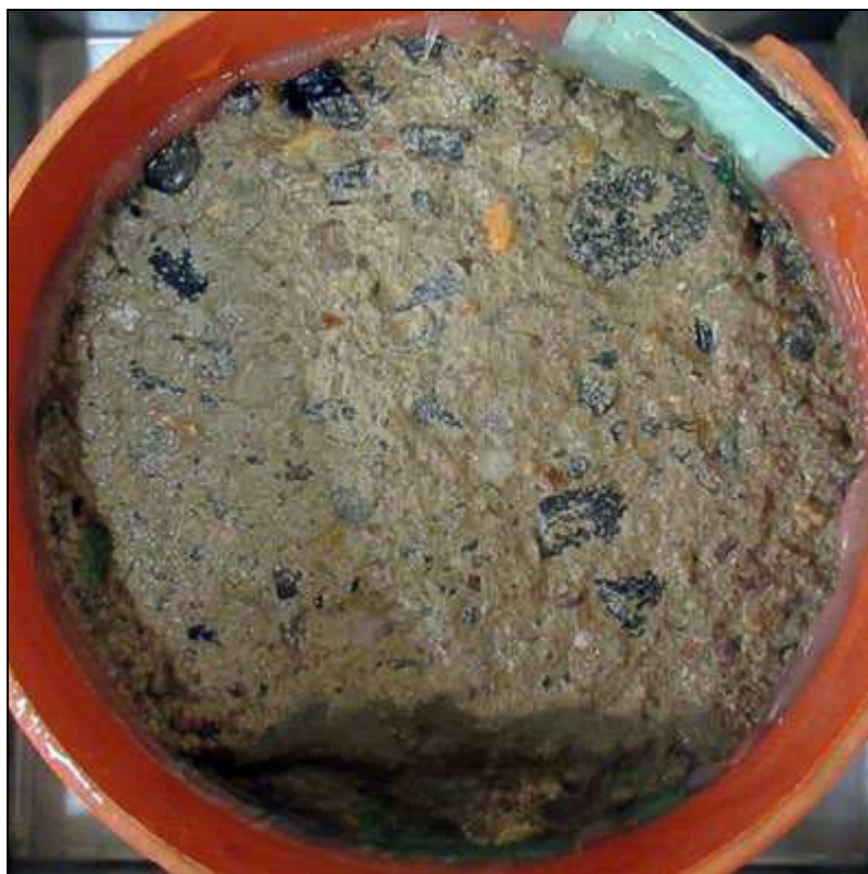
Foto 2: Pohled na líc vzorku V2 – po CH.R.L. - metoda C – 75 cyklů
