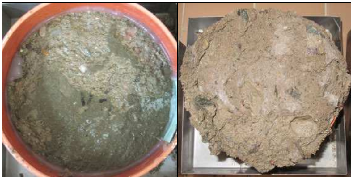
Foto 4: Pohled na líc a „dno“ vzorku V4 – po CH.R.L. - metoda C – 50 cyklů
