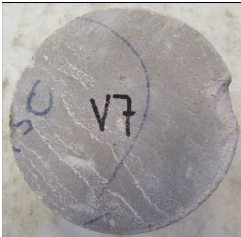
Foto 5: Pohled na líc vývrtu V7 před zkouškou
