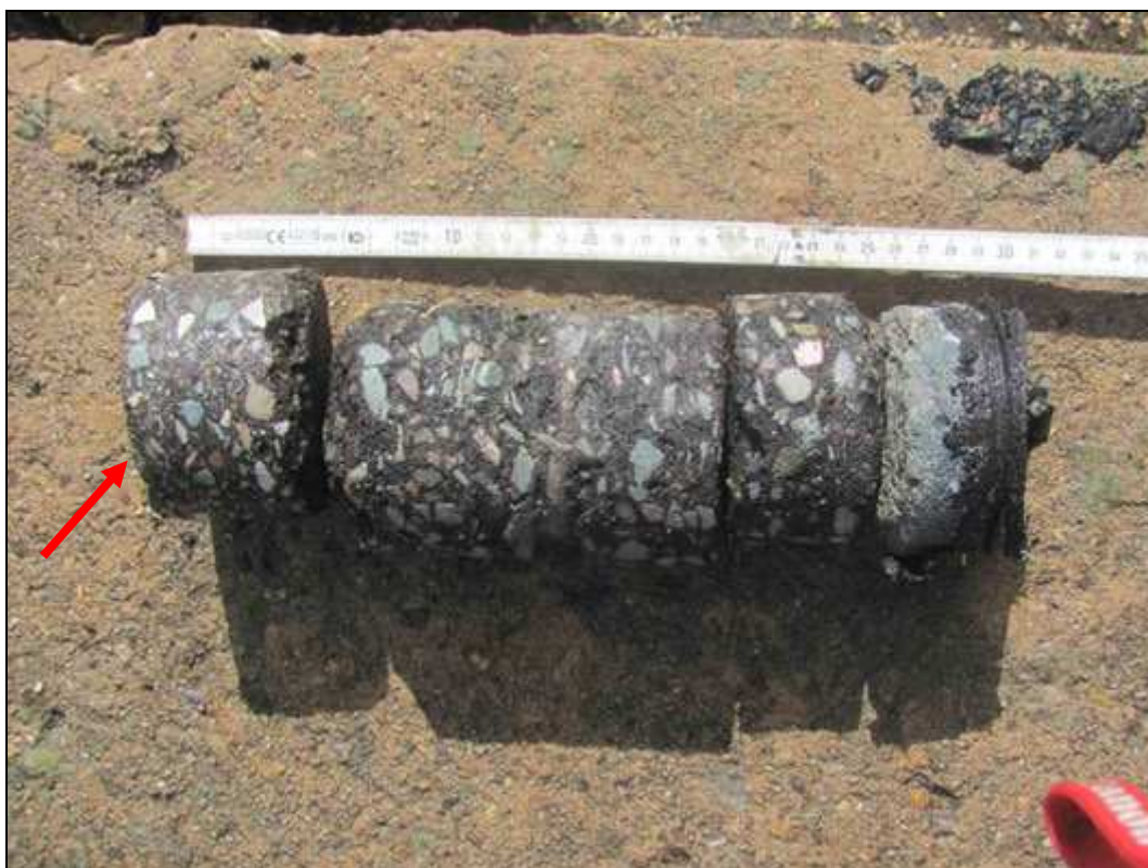
Foto 2: Pohled na výnos z vrtu V9 pro stanovení skladby vozovky. Šipkou vyznačen horní líc vozovky.
