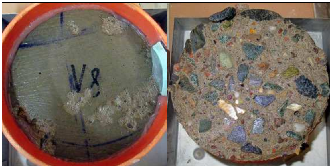
Foto 8: Pohled na líc a „dno“ vzorku V8 – po CH.R.L. - metoda C – 75 cyklů
