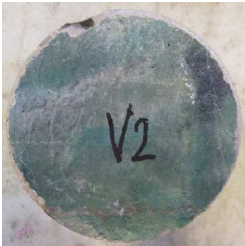
Foto 1: Pohled na líc vývrtu V2 před zkouškou
