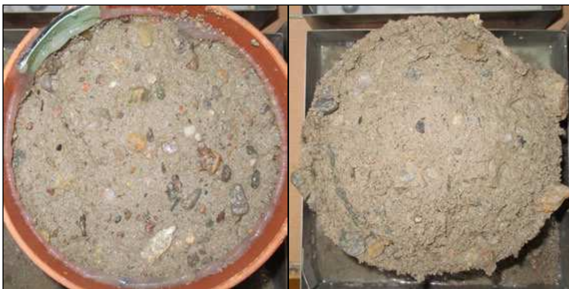
Foto 6: Pohled na líc a „dno“ vzorku V7 – po CH.R.L. - metoda C – 50 cyklů
